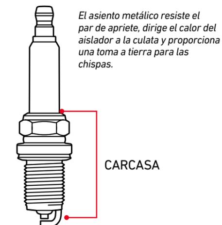
El **asiento** evita las fugas de la cámara de combustión gracias a su forma de cuña o la junta de compresión. Cada bujía tiene un tipo de asiento específico que no es intercambiable. Las bujías de encendido con un asiento plano se utilizan en motores diseñados para una junta estanca. Las bujías de encendido con un asiento cónico se utilizan en motores diseñados para una junta cónica.
